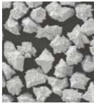
SPR N Diamant Beschichtung auf Nickelbasis 56 Gew.%
