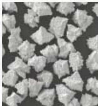
SPR N 30 Diamant Beschichtung auf Nickelbasis 30 Gew.%
