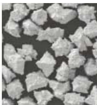
Diamanti SPR N Rivestimento con lega a base di nickel Livello di rivestimento 56% in peso
