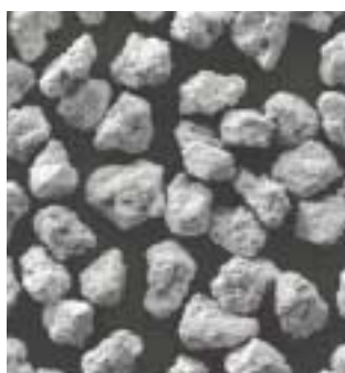
Diamante RVG 810 D Revestimento à base de liga de cobre Nível de revestimento 50% do peso
